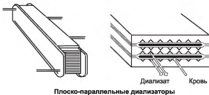
РИСУНОК 4.3. Поток крови и диализирующего раствора по капиллярному и плоско-параллельному диализатору. Видоизменено из: Man NK, Jungers P. Hemodialysis equipment. In: Hamburger J, Crosnier J, Grunfeld JP, eds. Nephrology . New York, NY: Wiley; 1979: 1206, 1207
